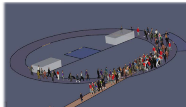
図：レストラン出火時の避難シミュレーション
