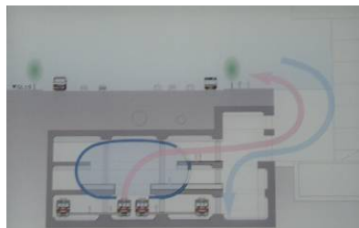
地下駅から外部につながる換気を提案しているが、火災時は？
